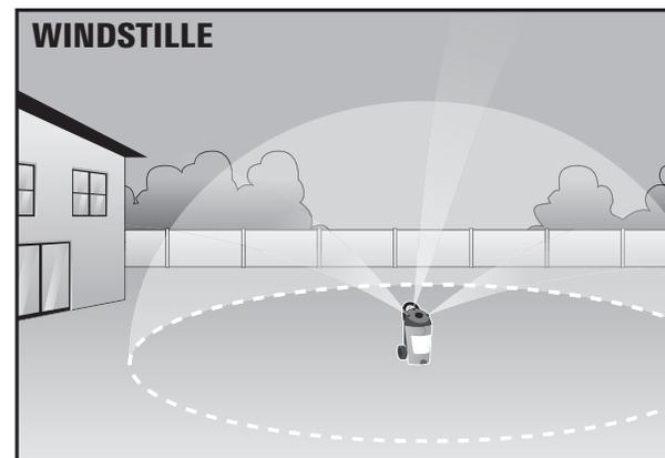
Positionieren sie den AntiMosquito-Wirkstoffzerstäuber im Zentrum des zu schützenden Bereiches, damit der Wirkstoff über dem zu schützenden Bereich gleichmäßig durch die Zerstäuberdüsen verteilt wird.
