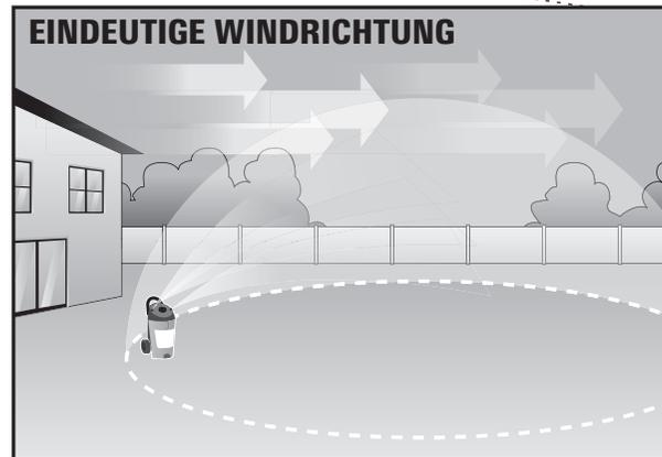
Positionieren sie den AntiMosquito-Wirkstoffzerstäuber in der Ecke des zu schützenden Bereiches und richten sie die Zerstäuberdüsen in den zu schützenden Bereich, damit der vorherrschende Wind den Wirkstoff über den zu schützenden Bereich verteilt.
